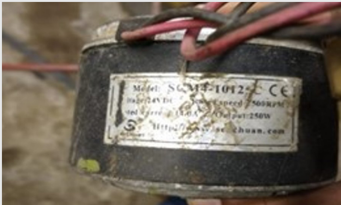
Figura 8. Motor eléctrico de 24 volts, 250 watts. Fuente Elaboración propia.
